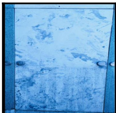
Figura 44 - Foto comparando parte da placa suja por um período de 02 anos em área próxima à BR e a parte de cima da placa limpa apenas com detergente neutro e estopa.
