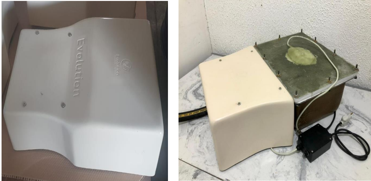
Figura 1 – Módulo evaporador / Evaporadora / válvula tripla
